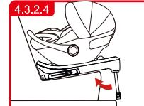
Infine, ruotare la gamba di supporto e inserirla nell'alloggiamento nel fondo del sedile.
