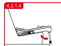
Drehen Sie schließlich das Stützbein und führen Sie es in den Schlitz unten am Sitz ein.
