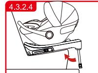
Gire la pierna de apoyo y insértela en la ranura en la parte inferior del asiento.
