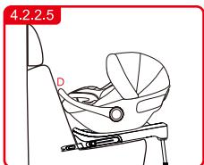
Stellen Sie sicher, dass sich der Griff in der oberen Position D befindet.
