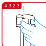
Apriete el botón de ajuste de la pata de soporte para retraer la pata de soporte.
