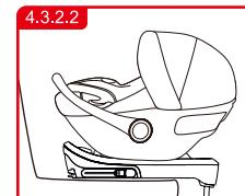
Drücken Sie die ISOFIX-Entriegelungstaste, um die ISOFIX-Verbindungen zu verschieben und die Basis und den Sitz zu trennen.
