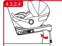
Drehen Sie schließlich das Stützbein und führen Sie es in den Schlitz an der Unterseite des Sitzes ein.
